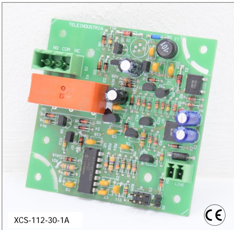
Scheda con relè per la ripetizione di chiamate telefoniche su linea analogica. Controllata da microprocessore e alimentata da linea telefonica.
